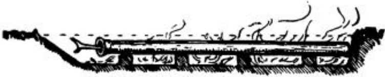
Horno de vapor en trinchera
