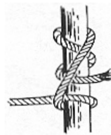
Ballestrinque doble para mayor resistencia.
