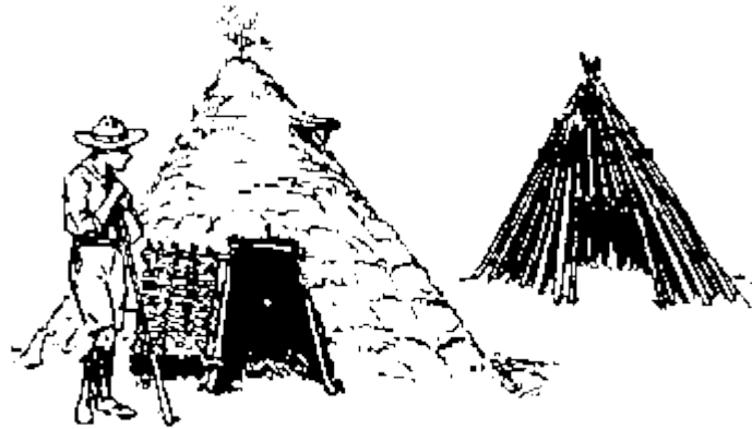
Juntando ramas endebles y cubriéndolas con césped, se puede construir una choza para una patrulla.
